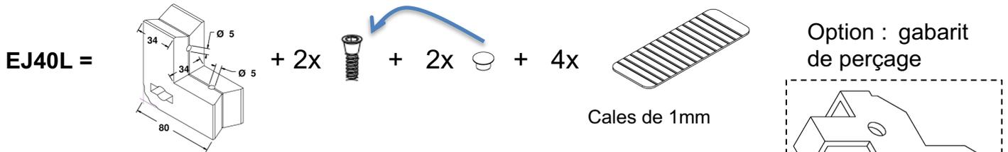
Pour un tube épaisseur 2mm, il faut insérer les 2 cales de 1mm fournies
