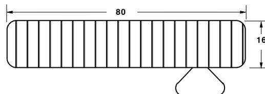
Epaisseur du vitrage jusqu'à 22mm
